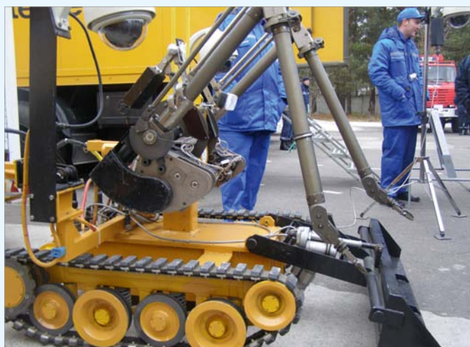
Протиаварійні навчання на РАЕС (м. Кузнецовськ). Виставка рятувального обладнання. Телекерований робот-маніпулятор для робіт в забруднених територіях та приміщеннях.
